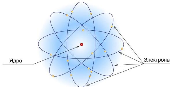
2. Ядро атома состоит из положительно заряженных частиц, названных **протонами**, и из частиц, не имеющих электрического заряда, — **нейтронов**.
