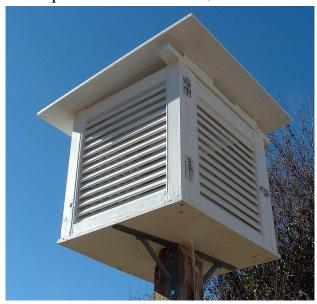
На открытой площадке размещают измерительные приборы в специальной метеорологической будке (на высоте 2 м). Будка окрашена в белый цвет для меньшего нагрева и имеет жалюзи для свободного доступа воздуха к приборам. На метеостанциях используют одинаковые приборы. Измерения производят каждые 3 часа.
